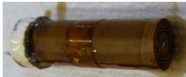
Zersetzung des Elektrolyten und Zerstörung der positiven Elektrode
