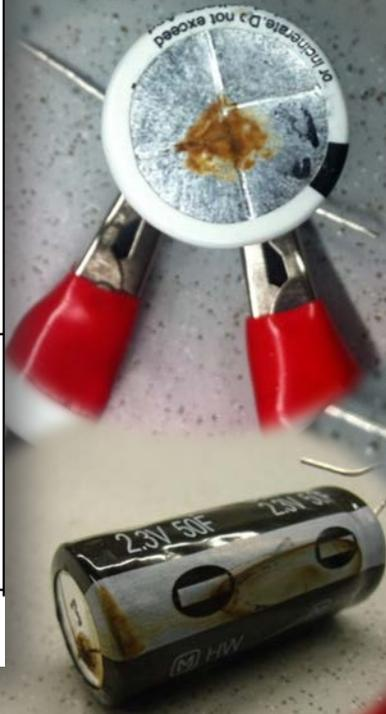
Zerstörung der Aktivkohle-Aluminium-Kompositelektrode
