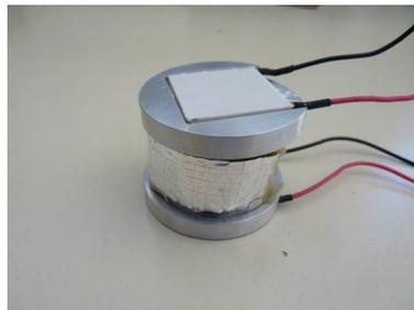
**Abbildung 46:** Adapter für den thermoelektrischen Generator
