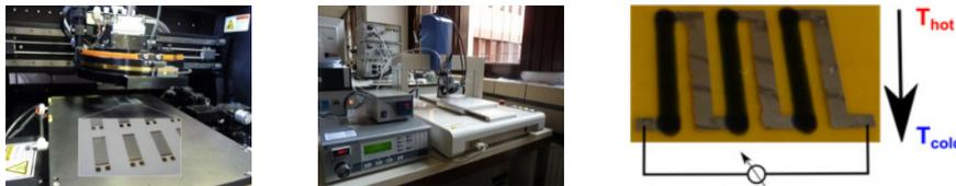
Abbildung: Drucktechnische Herstellung eines dreischenkigen TEG (rechts) mittels Inkjetdruck- (links) und Jet-Dispense-Verfahren (Mitte)
