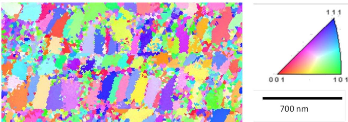
Abbildung: Germanium-Nanostruktur mit unterschiedlichen Kristallorientierungen
